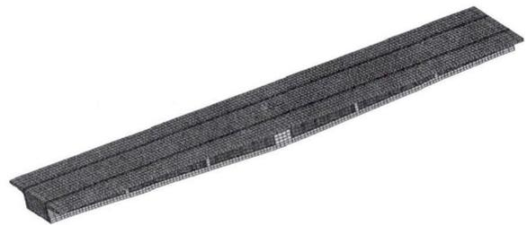
图8 模型试验梁的有限元计算模型
