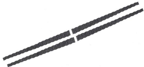
图9 波形钢腹板的有限元模型
