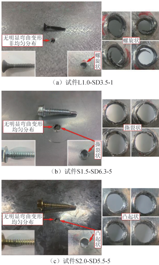
图 5 典型螺纹剪切破坏
